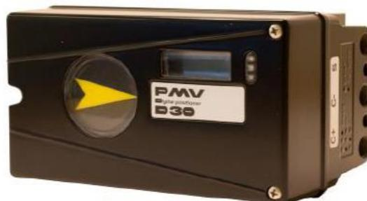
PMV D30 Digital lägesställare erbjuder intelligent och tillförlitlig ventilstyrning. Dess kompakta design med en mängd olika monteringsmöjligheter gör den perfekt för alla ventiler. Den är tillgänglig med 4-20 mA och HART-kommunikation plus integrerade gränslägesbrytare och lägesåterföring. Användarvänligt menysystem med grafisk LCD-display plus LED-indikering är standard.
